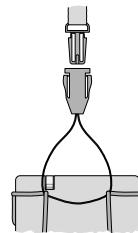
tirez la boucle de fixation de la courroie via l'étrier ; en déplaçant le bouton sur la bandoulière, réglez la longueur voulue puis passez la bandoulière autour du cou. En déverrouillant le système de fixation, (» schéma gauche), vous pouvez retirer facilement l'appareil et le remplacer par un autre.
