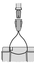
Die Befestigungsschlaufe des Bands über den Bügel ziehen, durch Verschieben des Druckknopfes am Band die gewünschte Bandlänge einstellen und das Band um den Hals hängen. Durch Entriegeln der Schnappvorrichtung (Abb. links) lässt sich das Gerät leicht wieder abnehmen und gegen ein anderes austauschen.
