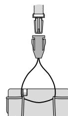
Para ponerse el emisor/receptor, ponga la pinza (5) en su ropa (p.ej. en el cinturón o en el bolsillo del pantalón) o utilice la diadema: Tire del lazo de la cinta por la pinza, deslice el pulsador de la cinta para ajustar su longitud y pase la cinta por su cuello. Abriendo el cierre (figura de la izquierda), el aparato se puede quitar fácilmente e intercambiar por otro.
