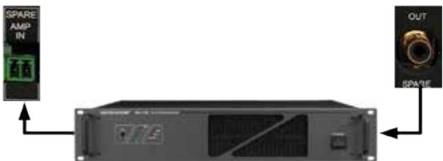
Abb. 5 Anschluss eines Havarie-Verstärkers
