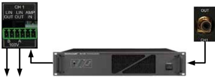
Abb. 4 Anschluss eines Standard-Verstärkers
